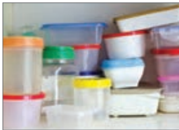
■ شکل ۶-۲- ظروف تولید شده به روش تزریق
